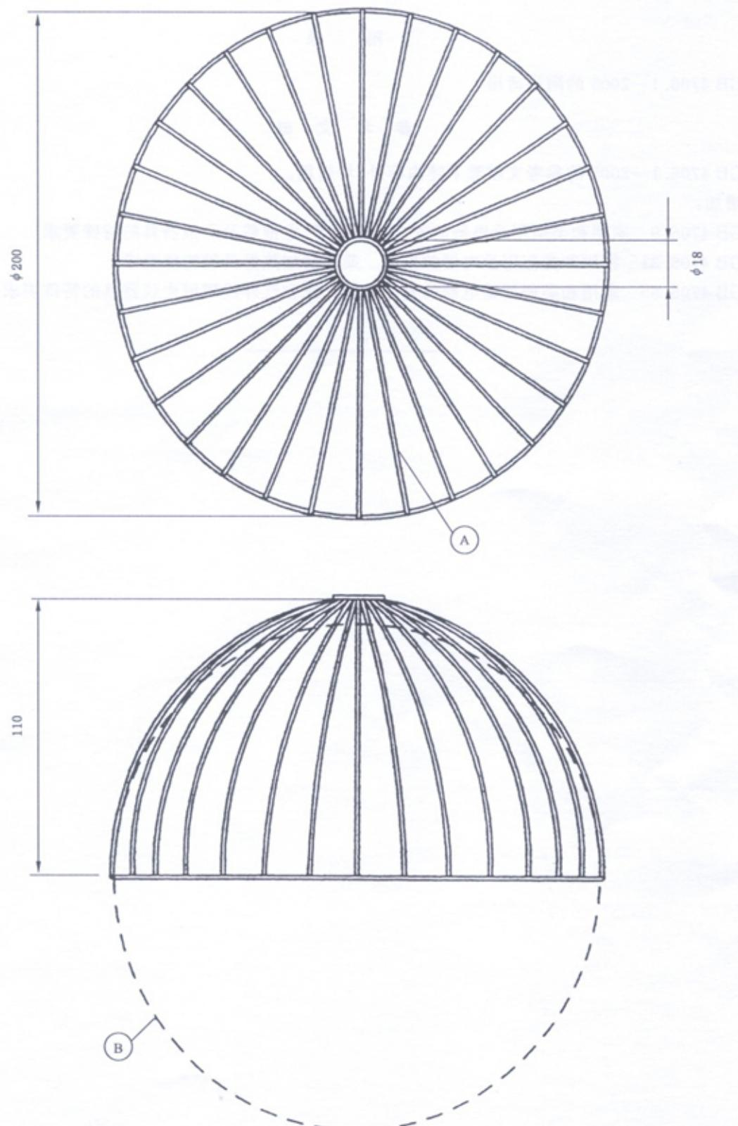
A——由 32 个等距丝线( $\phi 1.5 \text{ mm} \pm 0.5 \text{ mm}$ )组成的框架。
